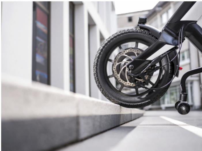
*Hohe Sicherheit bei Unebenheiten und Hindernissen: Dank des kompakten Antriebsrads mit dicker Balloon-Luftbereifung überwindet der e-pilot P15 sogar Bordsteine. Das Rad bleibt sicher in der Spur.*
