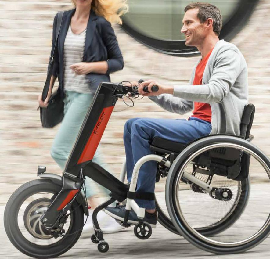
Für den e-pilot bietet Alber jetzt mit der neuen Tetra-Bremse eine Bedienmöglichkeit, die speziell für Tetraplegiker mit eingeschränkter Finger- und Handfunktion entwickelt wurde. Eine Handschleife und die Ergonomie der Handauflage verhindert das Wegrutschen der Hand und gewährleistet dadurch deutlich mehr Sicherheit beim Bremsen.
