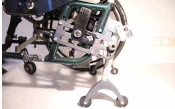
Schnell montiert: Die leichte Anbauplatte fällt kaum ins Gewicht und die Kippstützen dienen zusätzlich als Aufbockhilfe
