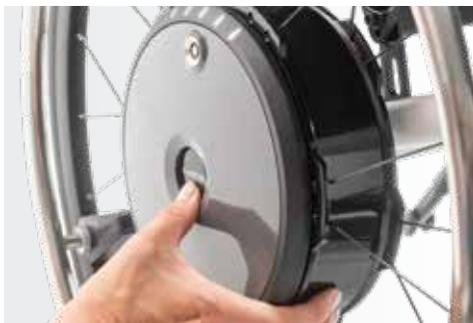
Rapide et simple : un bouton d'axe à démontage rapide permet de monter et de démonter les roues e-motion en un tour de main
