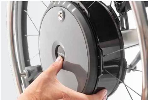
Schnell und einfach: Die e-motion Räder lassen sich mittels Schnellverschluss im Handumdrehen aufstecken und wieder abnehmen.
