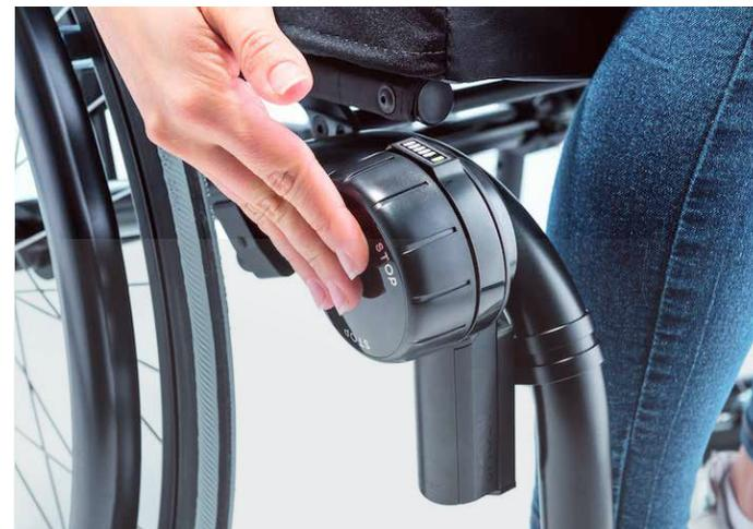
Eine Drehung am Bediengerät reicht aus und du wechselst während der Fahrt in den Cruise-Mode.
