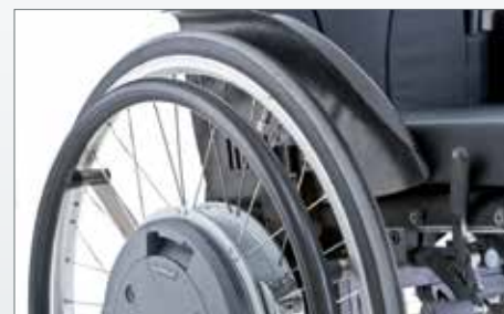
Beschichtete Greifreifen für besseren Grip
