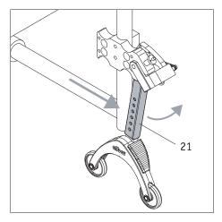
• Cuando haya instalado las ruedas puede devolver los apoyos anti-vuelco a su posición inicial. Para ello, haga avanzar la silla de ruedas, desplazando al mismo tiempo la barra de sujeción [21] hacia atrás con el pie,
