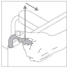
Al mismo tiempo, tire de la silla, agarrándola por los asideros que tenga, levemente hacia arriba y hacia atrás, hasta que los apoyos anti-vuelco encajen en una posición fija.
