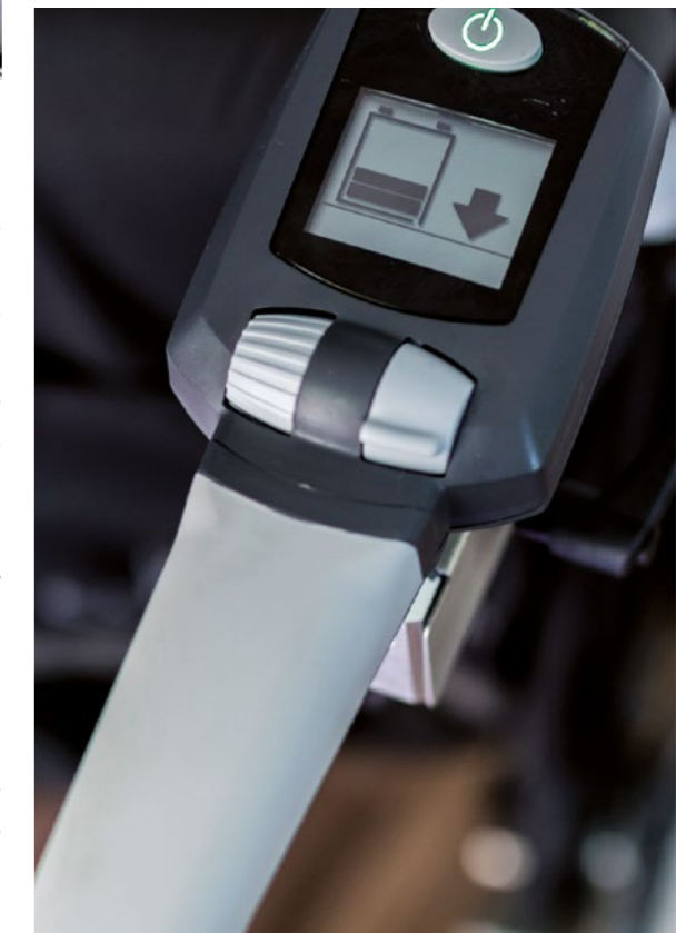
Steuerfiliale: Die Begleitsteuerung ermöglicht auch schiebenden Personen, die Funktionen des Antriebs zu nutzen
