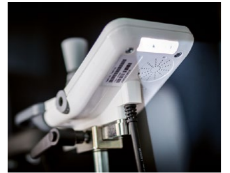
Zusatznutzen: Die Bedienkonsole beleuchtet auf Wunsch den Fahrweg in der Dunkelheit
