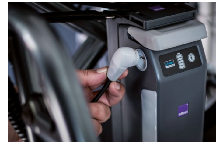
Selbsthaftend: Der verpolungssicher gestaltete Stecker findet fast von selbst seinen Weg in die groß dimensionierte Buchse
