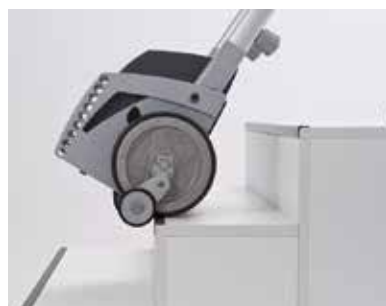
Approcher le scalamobil au bord de la marche ...
