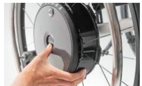
Het wiel kan eraf worden gehaald door de knop op de quick-release assen in te drukken en het wiel eraf te nemen.
