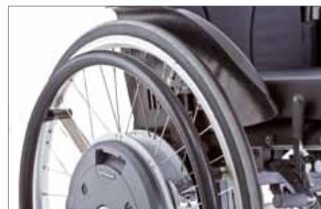
Beschichtete Greifreifen für besseren Grip
