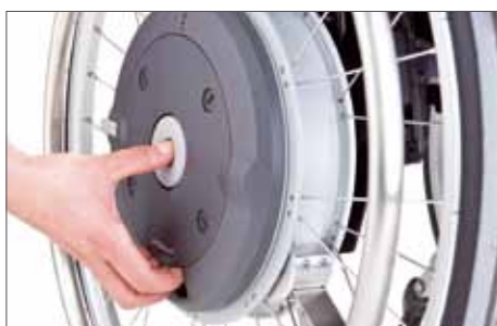
Abnahme des e-motion Rades vom Rollstuhl
