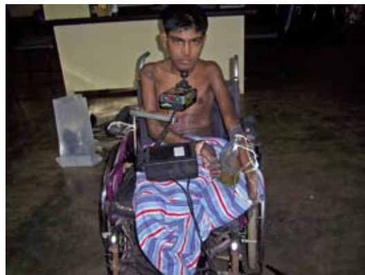
In seinem Rollstuhl mit e-fix Antrieb kann sich der 18-jährige Anton Jegan wieder selbstständig fortbewegen. Den Joystick als Kinnsteuerung hat Hans-Peter Dentler kreiert.
